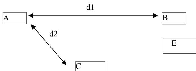
La construction A est isolée si  $d1+d2 > 200m$
