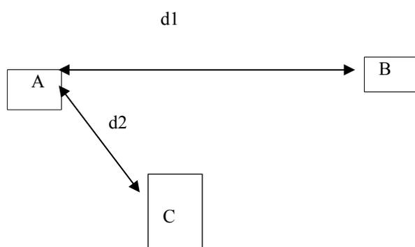
La construction A est isolée si  $d1+d2 > 140m$
