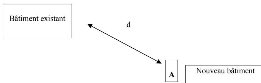
La construction A est isolée si  $d > 25 m$
